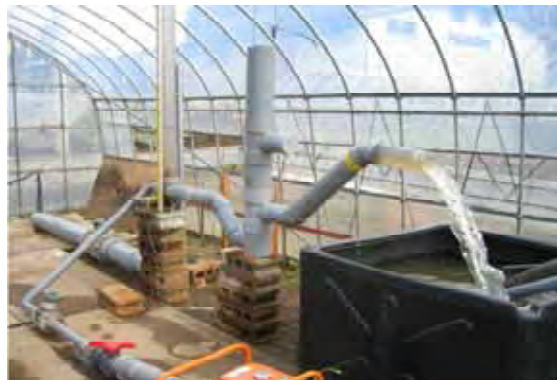
写真4 決定した水閘の構造
