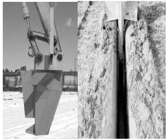
写真9 溝形成部及び施工断面
