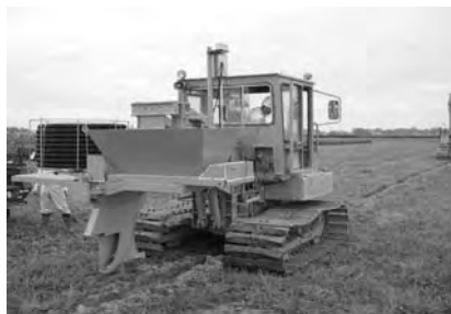
写真4 ベストドレーンの全景
